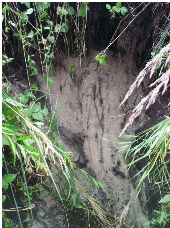
Foto 2: Zasucující se bagrovaná sonda BG3, která zastihla sanaci budovanou jemnozrnným zaobleným nesoudrzným štěrkem.
