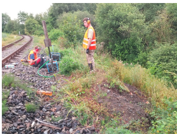
Foto 7: Umístění těžké dynamické penetrace DPH8.
