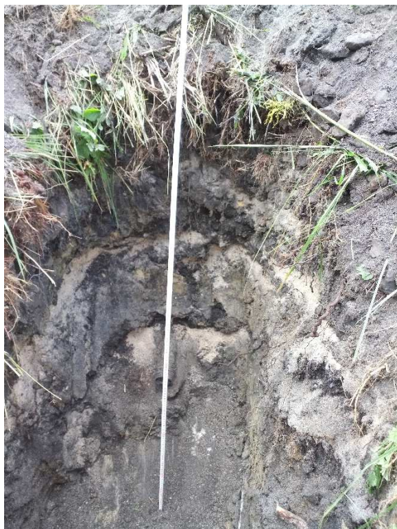
Foto 3: Svrchní část profilu sondou BG4, různorodé střídající se navážky..
