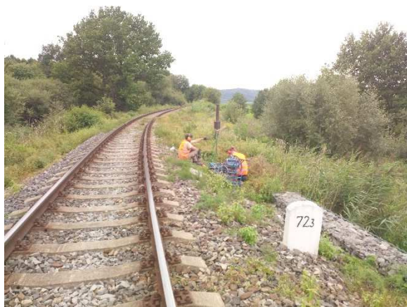
Foto 5: Umístění těžké dynamické penetrace DPH6.
